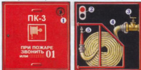
ПРЕДНАЗНАЧЕН для тушения пожаров и загораний веществ и материалов, кроме электроустановок под напряжением
